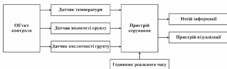
Рисунок 1 – Структура стенда системи збору та візуалізації інформації про стан ґрунту верміферми
